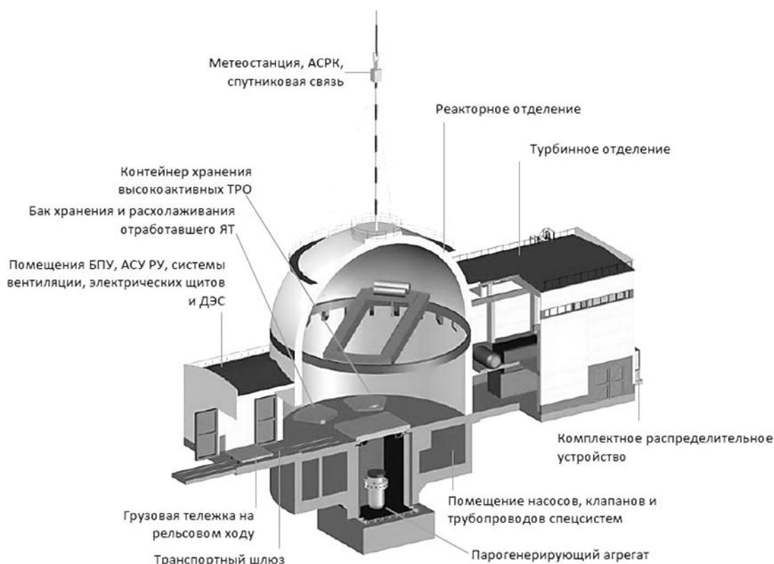
Рис.4.Общий вид АСММ с реакторной установкой АБВ-6 в подземном исполнении
