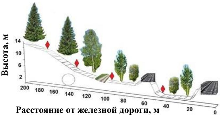
С приближением к магистралям происходит накопление тяжелых металлов в почве, опаде и древесине лиственных пород. Электрификация железнодорожного транспорта сопровождалась снижением содержания марганца, меди, свинца и цинка в древесине исследуемых растений.
