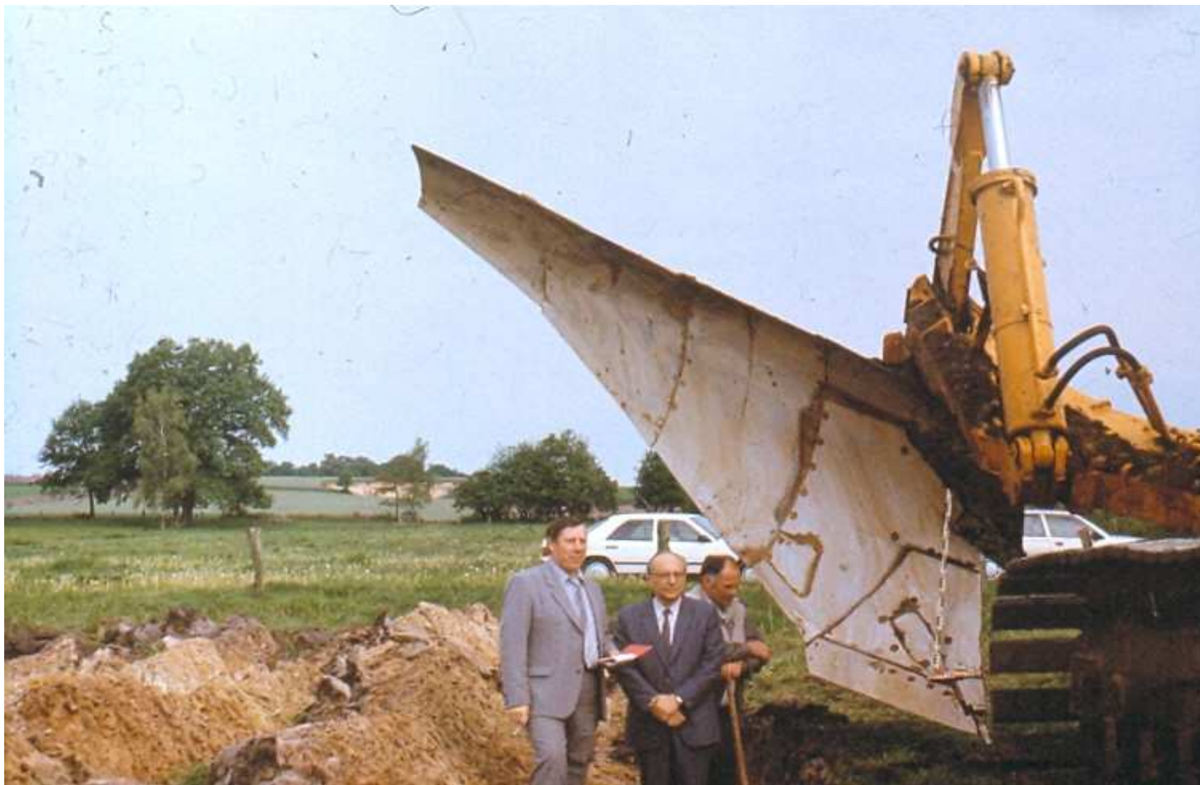
Лемех и отвал плуга В.Оттомайера для создания немецкой смешанно-слойной культуры земледелия на осушаемых торфяных почвах
