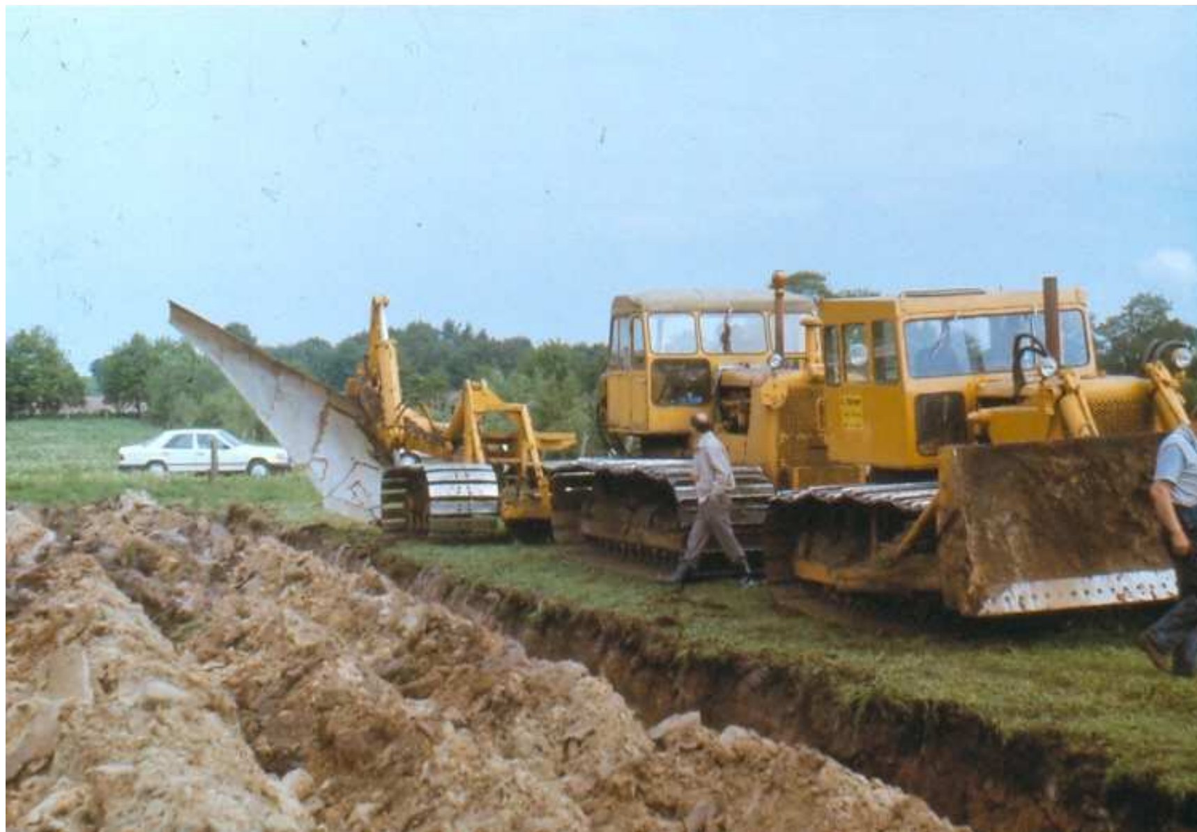
Агрегат для глубокой пахоты осушаемых торфяных почв с использованием плуга В.Оттомайера при создании немецкой смешанно-слойной культуры земледелия
