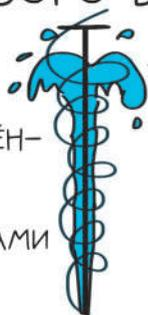
**СКВАЖИНА** — ЭТО КРУГЛОЕ ОТВЕРСТИЕ НЕБОЛЬШОГО ДИАМЕТРА (ЧАЩЕ ВСЕГО ОТ 5 ДО 30 СМ), ПРОБУРЕННОЕ В ГОРНЫХ ПОРОДАХ НА ГЛУБИНУ ОТ ПЕРВЫХ МЕТРОВ ДО НЕСКОЛЬКИХ КИЛОМЕТРОВ. СКВАЖИНЫ НУЖНЫ ДЛЯ ИЗВЛЕЧЕНИЯ ЖИДКИХ И ГАЗООБРАЗНЫХ ПОЛЕЗНЫХ ИСКОПАЕМЫХ (ПОДЗЕМНЫХ ВОД, НЕФТИ, ГАЗА), А ТАКЖЕ НАУЧНЫХ И ИНЖЕНЕРНЫХ ИССЛЕДОВАНИЙ.
