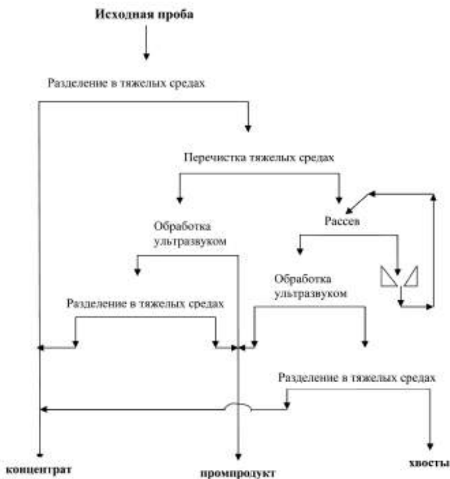
Рис. 6. Схема выделения антраксолита из горизонта туфопесчаников Нигозерского месторождения, содержащего антраксолитовые стяжения
