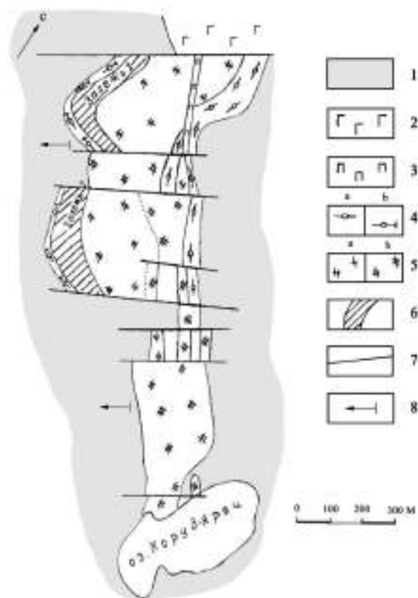
Рис. 4. Схематическое геологическое строение участка проявления тальковых руд Игнойла [8]
