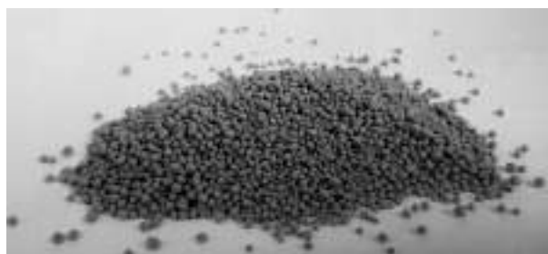
Рис. 2. Гранулированный реагент для очистки воды от тяжелых металлов, полученный на основе серпентинитов
