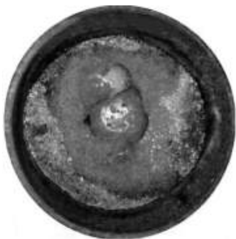
Рис. 2. Продукты восстановления рудоугольных титаномагнетитовых брикетов (2,2% TiO_2 ): в центре – плав железа, обособленный в титановом шлаке. Видеокادر тепловизора Pyrovision M900 фирмы Micron, США [10]
