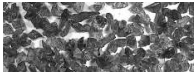
Рис. 2. Продукт электроимпульсной дезинтеграции граната, фракция –1+0.5 мм
