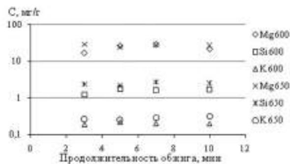
Рис. 7. Влияние температуры и продолжительности термообработки на содержание доступных компонентов в образцах вермикулитового субстрата (температура обжига указана на графике)
