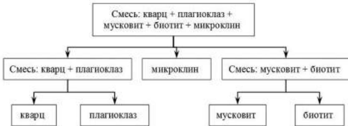
Рис. 6. Рабочая схема разделения компонентов полевошпатового сырья
