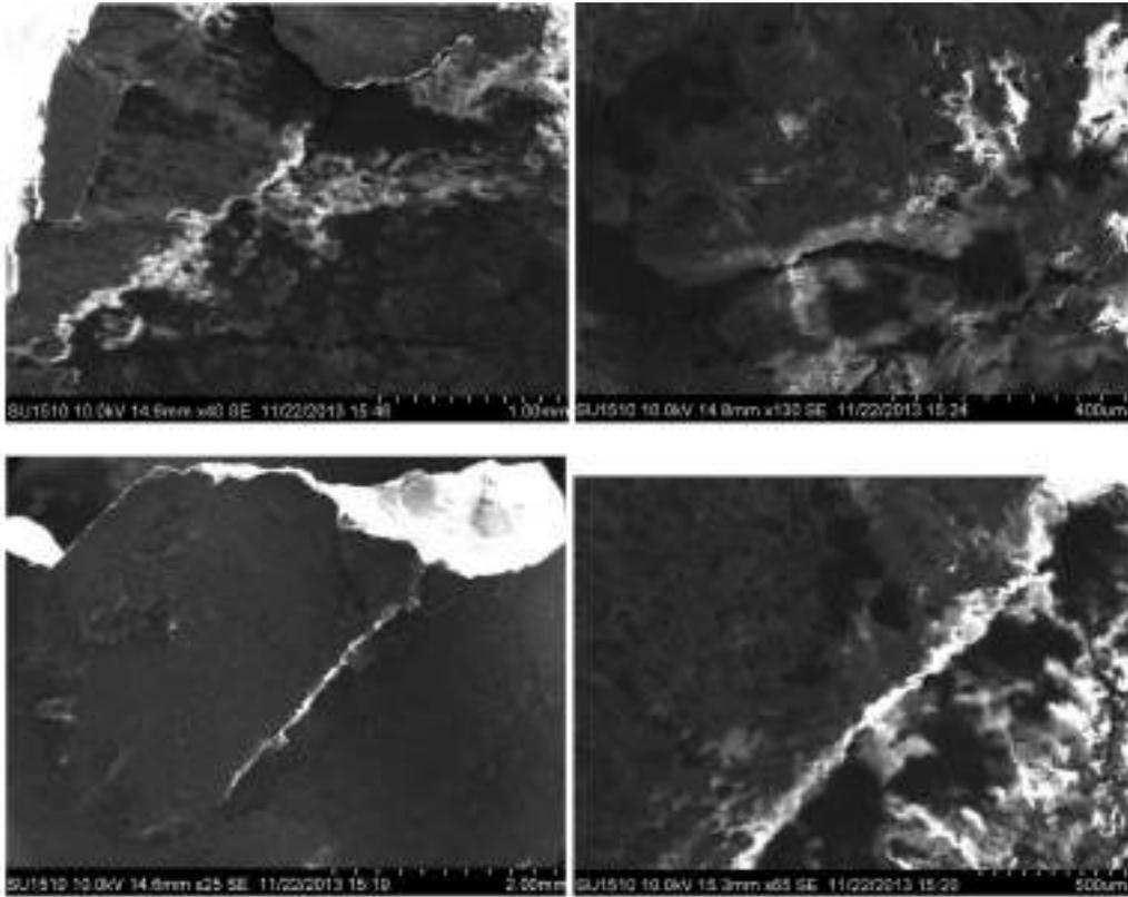
Рис. 1. Микротрещины на контактах зерен (гранит)
