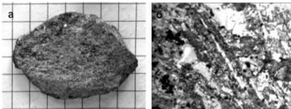
Рис. 2. Неоднородность зёрен щебня из габбро-диабазы Круторожинского месторождения: а – неоднородная поверхность зерна, б – минеральная неоднородность (микрофотография увеличение 100)
