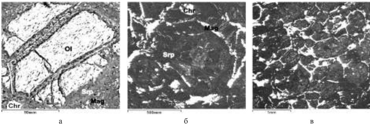
Рис. 3. Микрофотографии серпентинита (проба C-10-25): а – замещение оливины лизардитом; б – псевдоморфозы по оливину, сложенные серпентином различной железистости: наиболее светлые области соответствуют серпентину с высокой железистостью, темные – менее железистому серпентину; в – характер распределения рудных минералов. Chr – хромит, Mag – магнетит, Ol – оливин, Srp – серпентин
