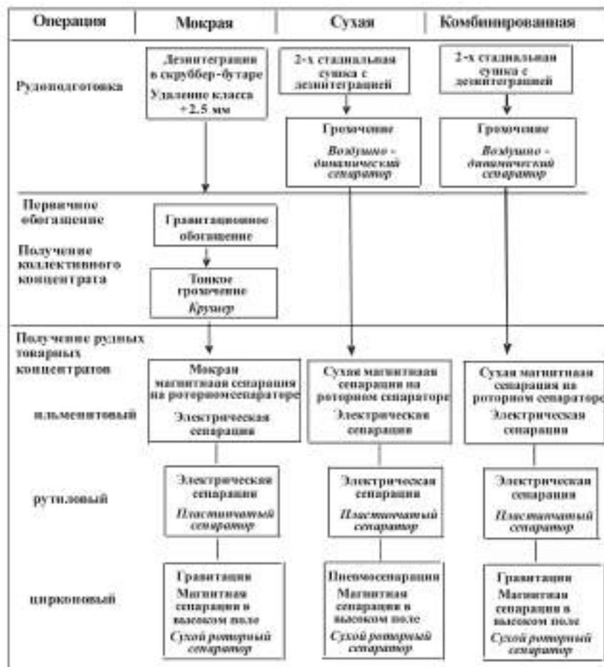
Рис. 2. Блок-диаграммы технологических схем переработки титано-циркониевых россыпей
