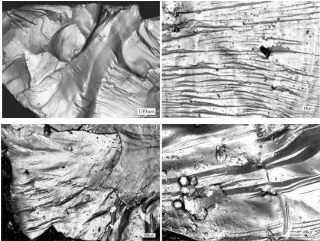
Рис. 2. Микродеформации, выходящие на поверхность зерен кварца (лазерный микроскоп Color 3D VK-9710K)
