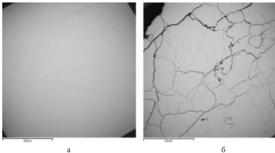
Рис. 3. Фото пластинок кварца: а – до обжига, б – после обжига (СЭМ VEGA II LMU)
