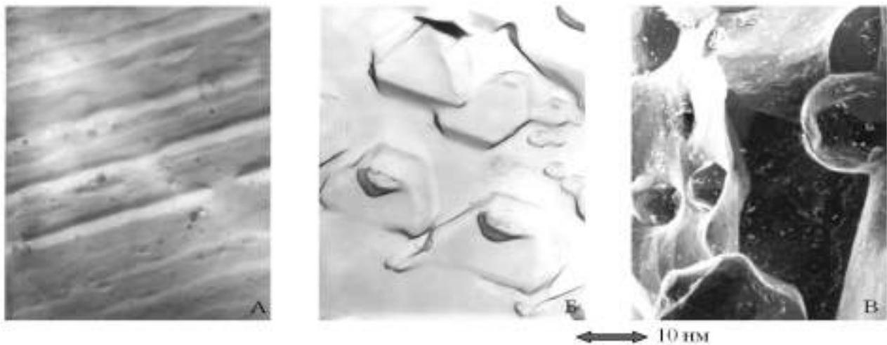
Рис. 4. Особенности микросрастаний минералов на наноуровне: наноблоки ильменита (А) и шпинели (Б) в матрице магномагнетита и форстерита (В) в апатите руд Ковдора (ЭМ, угольная реплика)
