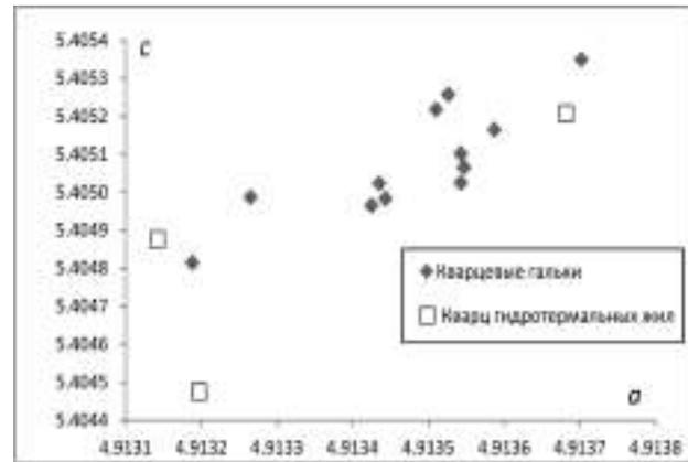
Рис. 3. Соотношение значений параметров  $a$  и  $c$  элементарной ячейки ( $\text{Å}$ ) в галечном кварце из конгломератов и промышленном кварце гидротермальных жил [3]
