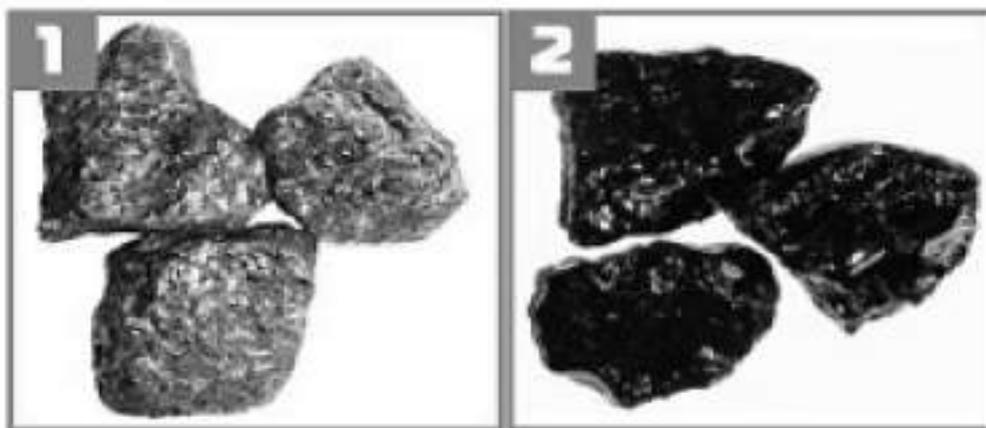
Рис. 3. Результаты испытания по ГОСТ 12801–98 качества сцепления битума с щебнем до введения присадки БП-КСП (1) и после (2). Исходные материалы: щебень габбродиабаз (ЗАО «Карьер Голодай Гора», Республика Карелия), битум БНД 90/130 (ЗАО «Рязанская НПК»)
