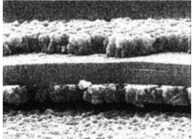
Рис. 4. Изображение частицы слюды, покрытой диоксидом титана
