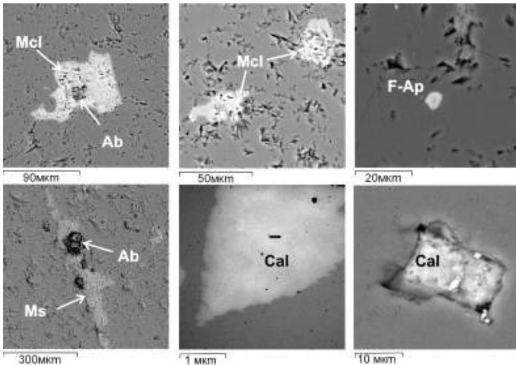
Рис. 6. Микроминеральные включения микроклина (Mcl), альбита (Ab), фторапатита (F-Ap), мусковита (Ms) и кальцита (Cal) в галечном кварце из конгломератов
