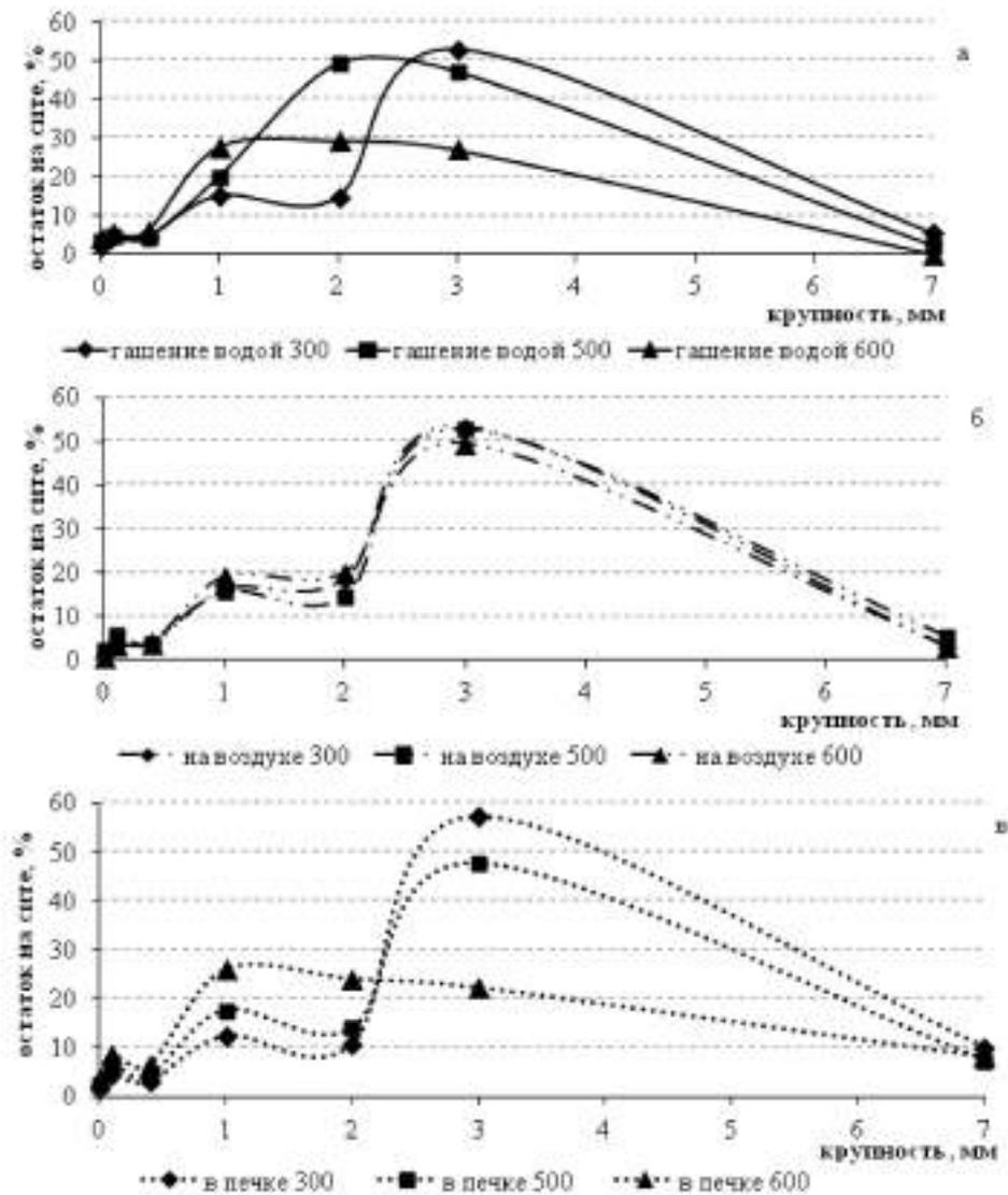
Рис. 6. Гранулометрия термообработанного в разных режимах кварца (проба М-2) с остыванием после нагрева: а – гашение водой; б – на воздухе; в – в печи
