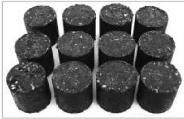
Рис. 5. Образцы регенерированного асфальтобетона, приготовленные для проведения испытаний на предел прочности при сжатии по ГОСТ 2801–98
