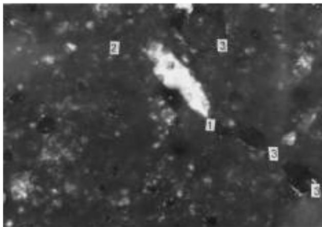
Рис. 2. Шамот, т/о 1350–1400С. Кристалл силлиманита (1) в шамоте (2): а – поляриды //, увел. ×150.
