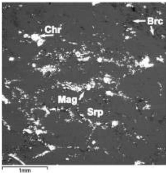
Рис. 4. Выделения рудных минералов по границам псевдоморфоз по оливину в пробе С-8-51,8. Brc – брусит, Mag – магнетит, Srp – серпентин (фото в отраженных электронах)
