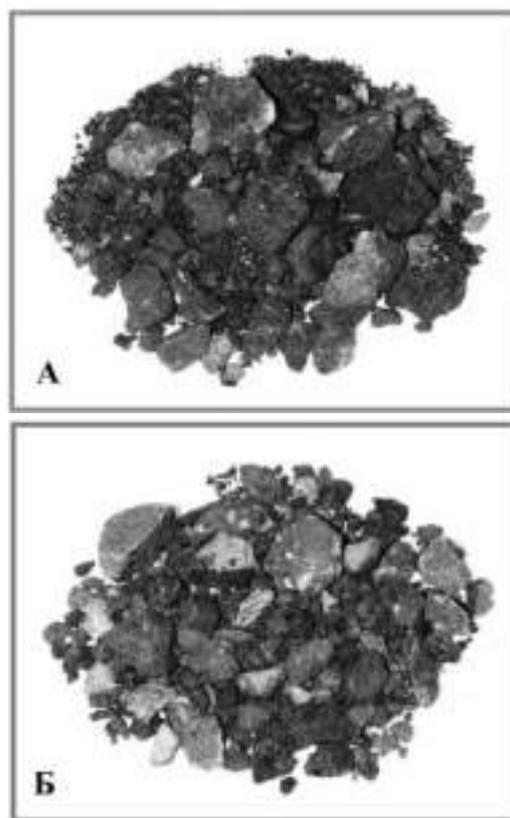
Рис. 4. Результаты испытания асфальтобетонного гранулята на сцепление по ГОСТ12801–98: А – асфальтобетонный гранулят до кипячения; Б – асфальтобетонный гранулят после кипячения
