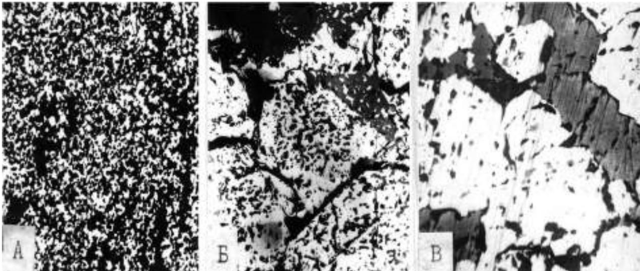
Рис. 2. Типы сростаний магнетита и кварца железистых кварцитов фации зеленых сланцев на анатомических срезах ксено- и идиобластических зерен: (А – микромикритовый, Б – пойкилитовый, В – субидиоморфный типы сростаний). Скелеватское месторождение (Кривой Рог, ЮГОК). Свет отраженный: белое – магнетит, черное и серое – кварц, николи II, увеличение 100
