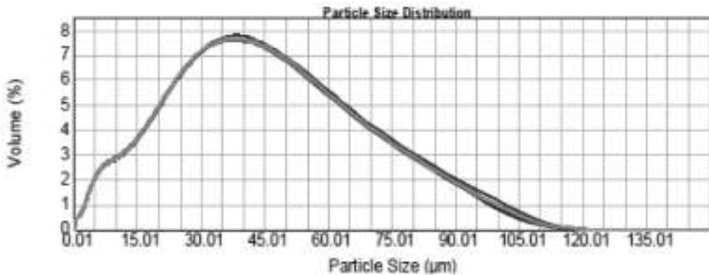
Рис. 3. Распределение частиц по размерам средней фракции (обогащенный глауконит)
