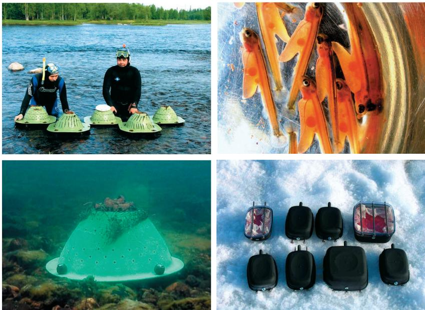
Рис. 9. Испытания разных вариантов конструкции искусственного гнезда-инкубатора в реках Умба и Лососинка
