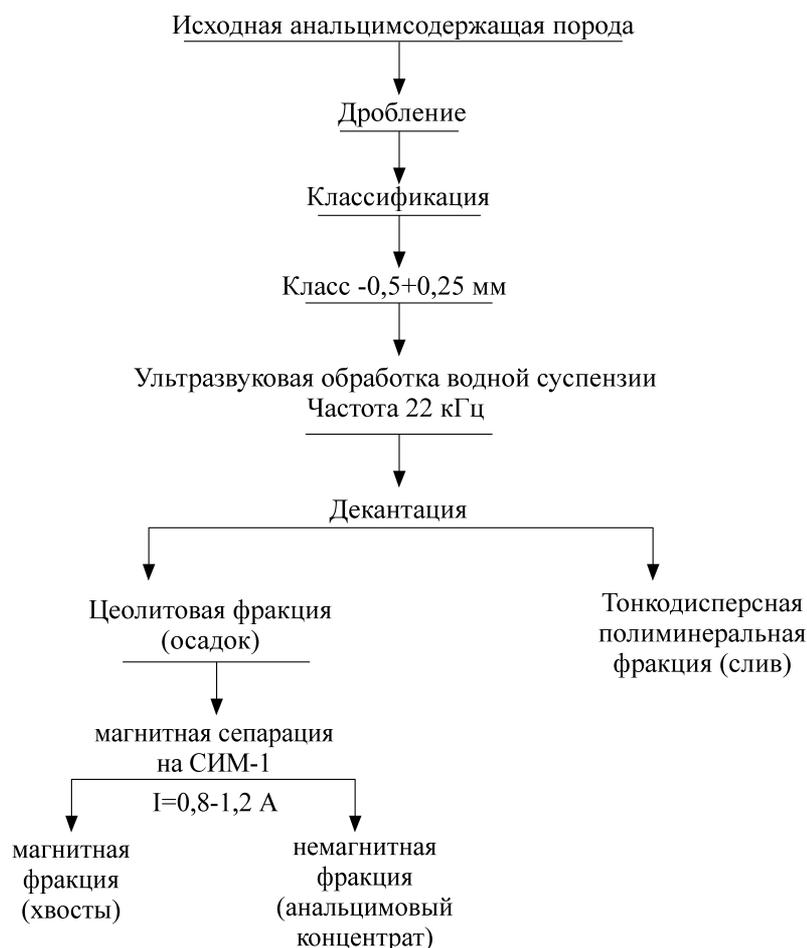
**Рис. 5. Технологическая схема обогащения анализимсодержащих пород**
