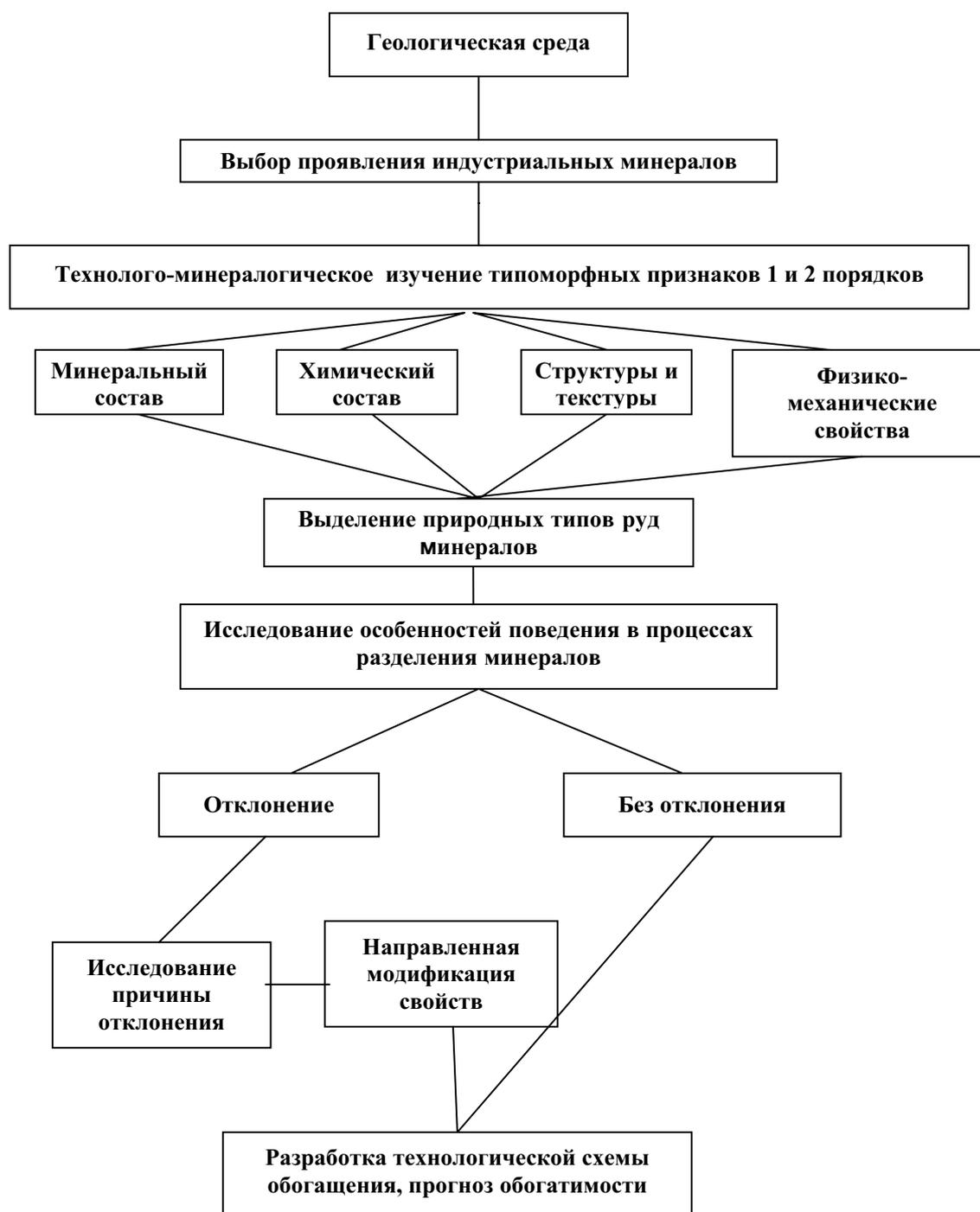
**Рис. 1. Блок-схема минералого-технологического изучения индустриальных минералов Карелии**
