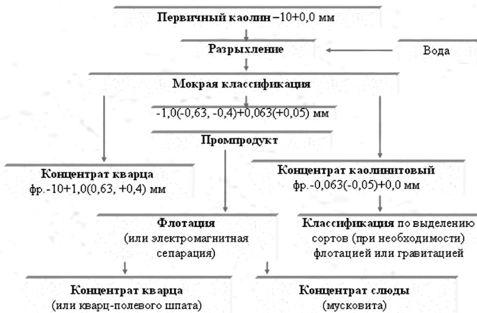
Рис. 5. Принципиальная схема обогащения первичных каолинов
