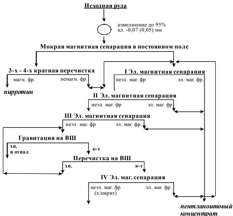
Рис. 10. Прогнозная схема обогащения Ni-Cu-Co руды месторождения Шануч
