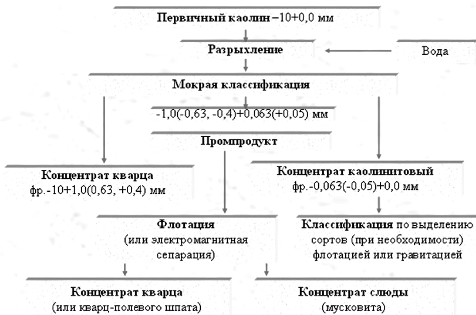
Рис. 5. Принципиальная схема обогащения первичных каолинов
