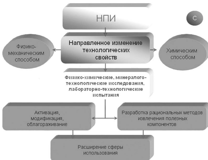
Рис. 6. Направленное изменение технологических свойств минералов, горных пород и руд (блок С)
