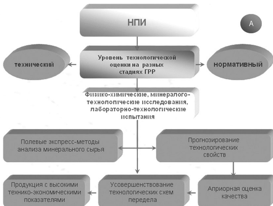
Рис. 2. Техническое и нормативное обеспечение минералого-технологических исследований (Блок А)
