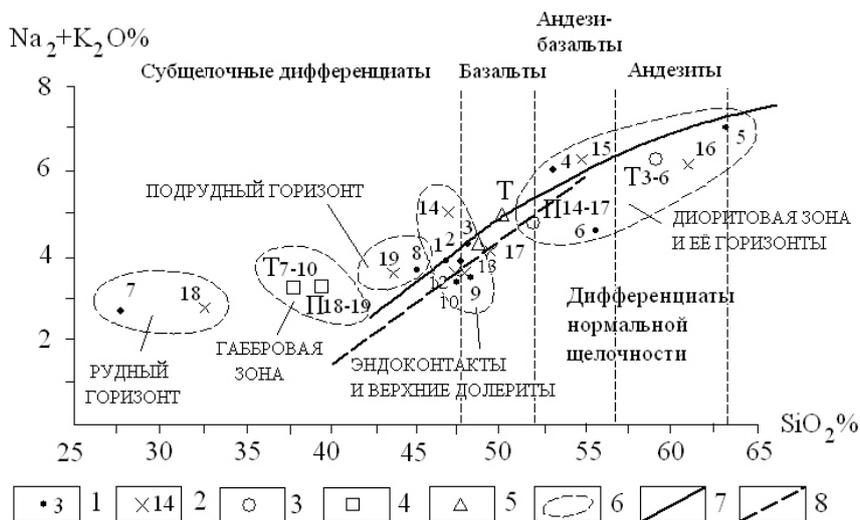
**Рис. 2. Классификационная диаграмма SiO<sub>2</sub> – (Na<sub>2</sub>O + K<sub>2</sub>O) для обобщенного химического состава слоев и горизонтов Пудожгорского месторождения и Тубозерского рудопроявления:**
