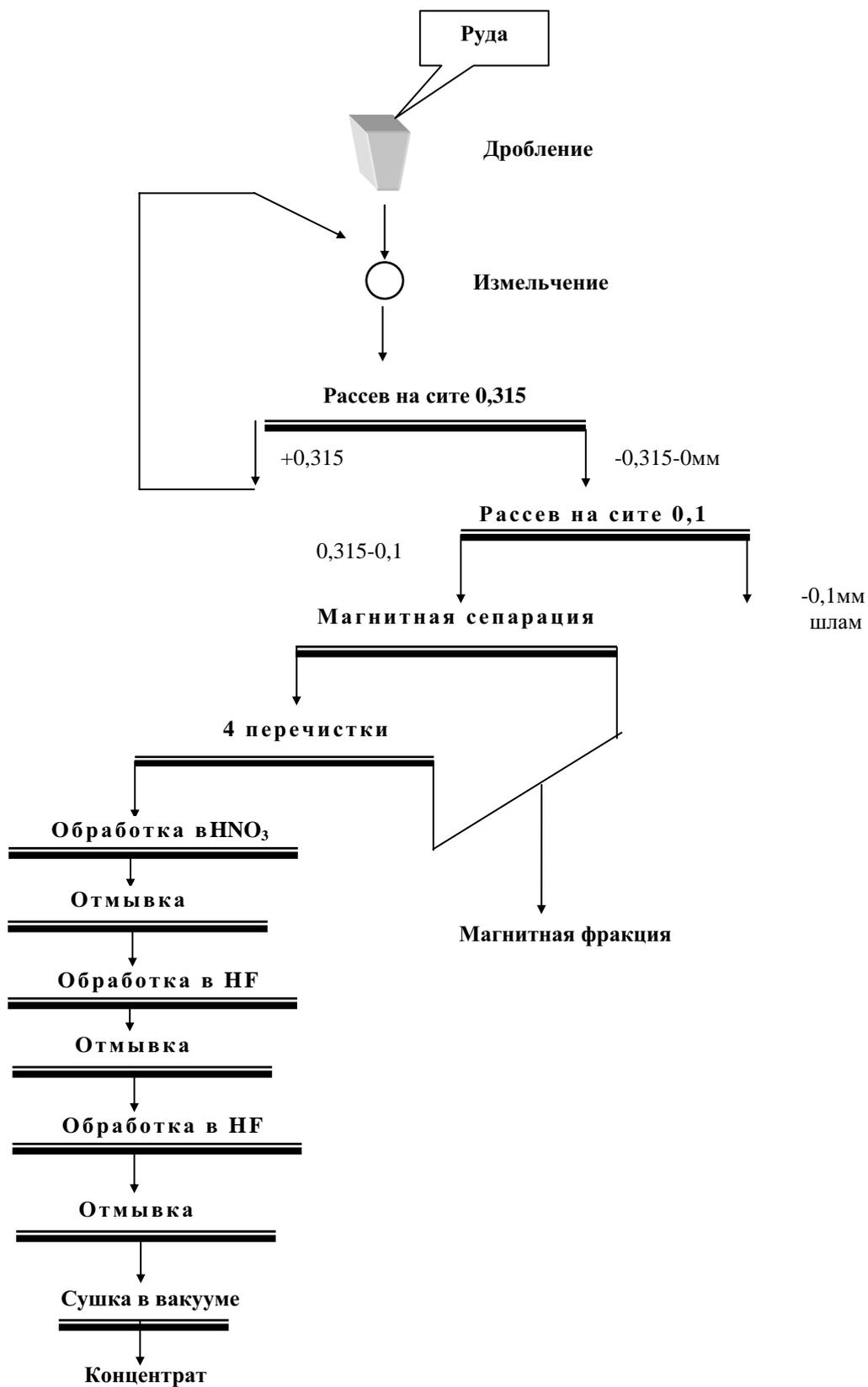
Рис. 10. Схема глубокого обогащения кварца в лаборатории ОАО «Полярный кварц»
