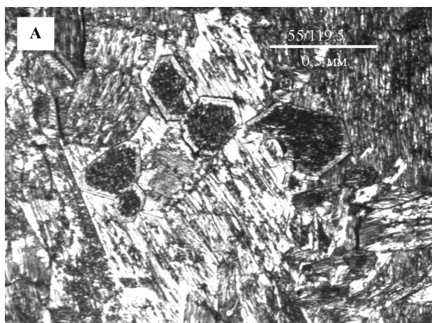
Рис. 2. Перекристаллизация гипса (gy) с образованием идиоморфных кристаллов и развитием по ним регенерационной каймы. Николы скрещены – А, шл. С55/119.5. Гипс, электронное изображение – Б, шл. С-55/114
