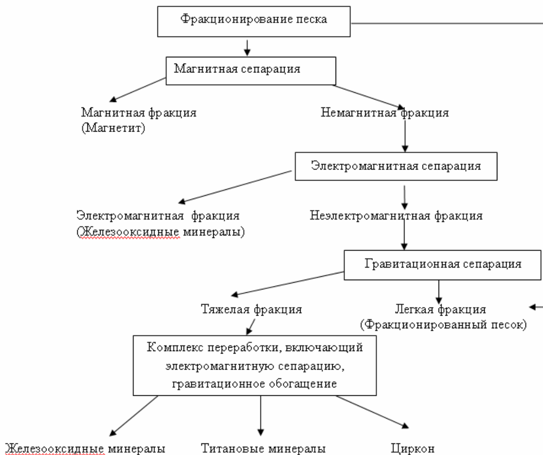
Рис.1. Технологическая схема комплексной переработки титан-циркониевых песков
