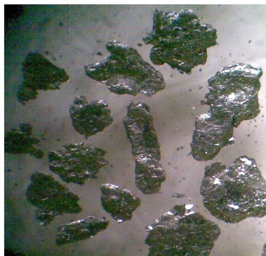
**Рис. 6. Поверхность агрегатов графита со следами углублений от сопутствующих породообразующих минералов, фракция  $-1,0+0,63$  мм**
