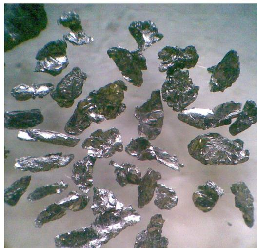
**Рис. 4. Чешуйчатые, шестоватые и пластинчатые агрегаты вскрытого графита, фракция  $-0,63+0,40$  мм**
