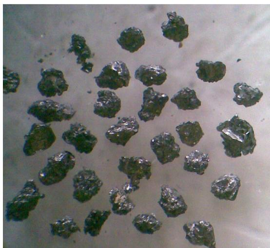
**Рис. 5. Зернистые агрегаты графита, состоящие из многих массивных микрокристаллов графита, цементированных кремнистым цементом, фракция  $-0,63+0,40$  мм**
