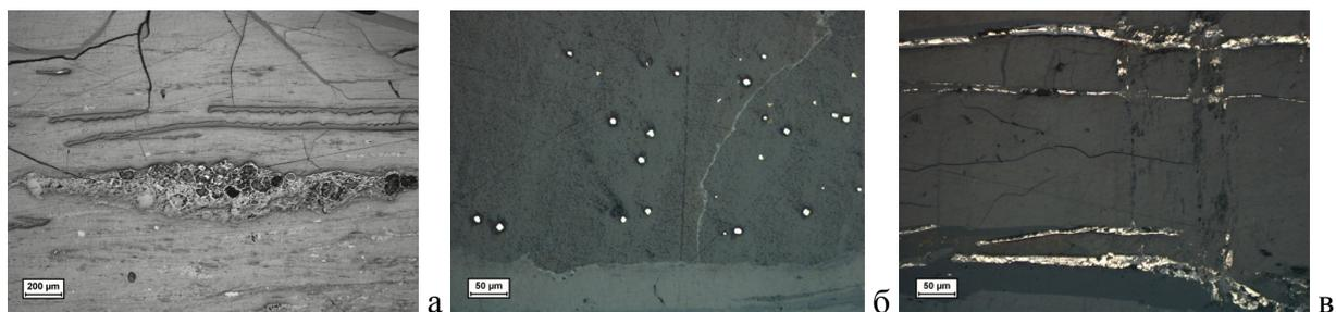
**Рис. 1. Микроструктурные особенности углей: а) гелифицированная масса угля с форменными элементами; б) мелко-тонкокристаллический пирит I генерации; в) марказит-пиритовые прожилки. Отраженный свет, николи параллельны**
