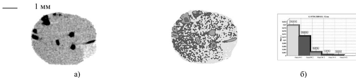
**Рис. 3. Рентгенотомография бурого угля: а) томограмма; б) обработка по TomAnalysis; сульфиды в окаймлении оксидов железа – темно-серое; гелифицированная масса – светло-серое и серое.**
