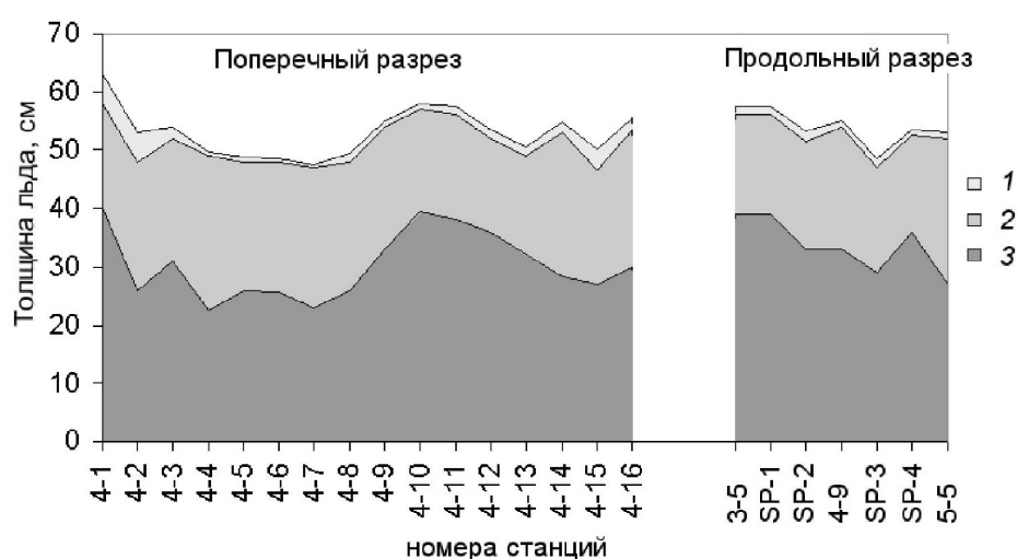
Рис. 6. Изменение толщины снежно-ледового покрова оз. Вендюрского вдоль поперечного (станции через 100 м) и продольного (через 250 м) разрезов 18.04.2006 г.:
