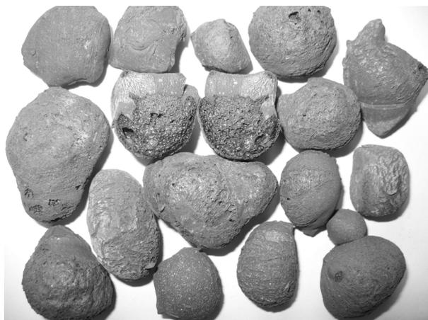
Рис. 1. Шунгизит – наполнитель легких бетонов
