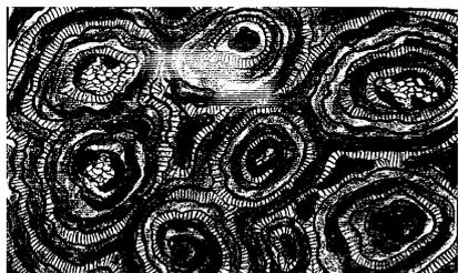
**Рис. 5. Овоидная текстура железисто-пирролюзитовой руды с кварц-кварцитовыми и гематитовыми «затравками» овоидов. Шурф 495. Уменьшение  $\times 2$**
