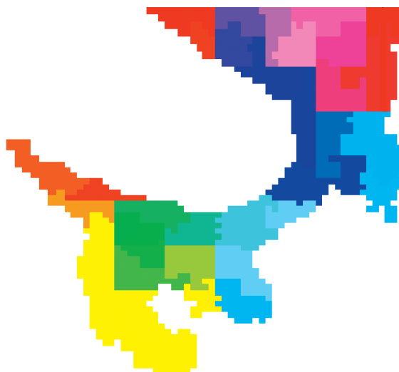
Рис. 4. Распределение областей Белого моря по процессорам. Разный размер областей связан с глубиной моря и балансировкой нагрузки, чтобы вся работа была поделена примерно поровну
