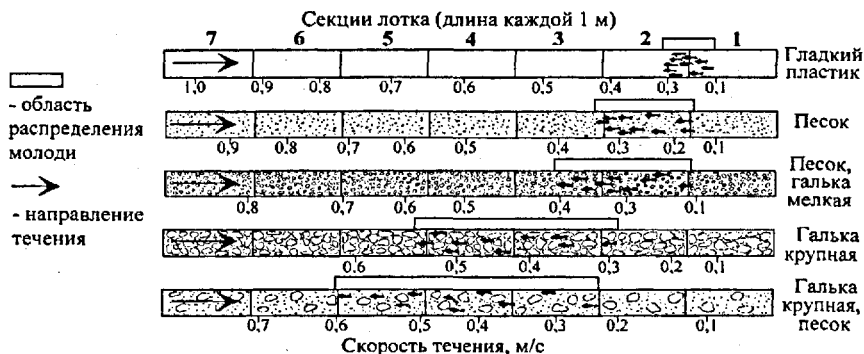
Рис. 10. Схема распределение пестряток лосося (возраст 1+, 2+) в лотке с разным фракционным составом грунтов.
