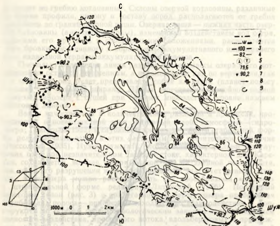
Рис. 1. Схематическая гидроморфологическая карта озерной котловины (Шотозеро). 1—гребень котловины; 2—береговая зона различных типов (обозначения см. табл. 2); 3, 4—горизонтали; 5—надводные и подводные камни; 6—отметка максимальной глубины озерной чаши; 7—отметка среднего многолетнего уровня воды; 8—направление стоковых течений в озере; 9—водоворотные зоны.
