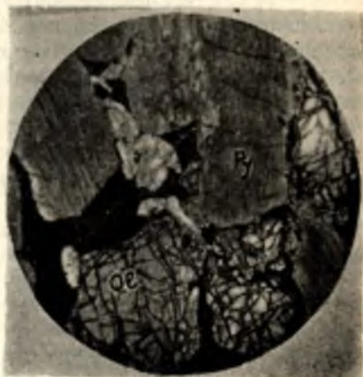
Рис. 3. Характер кристаллизации оливина и пироксена в рудном перидотите. Увеличение 20, николи 11
