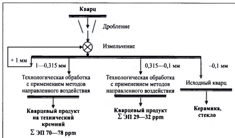
Рис. 4. Схема комплексного использования кварцевого сырья жилы Меломайс
