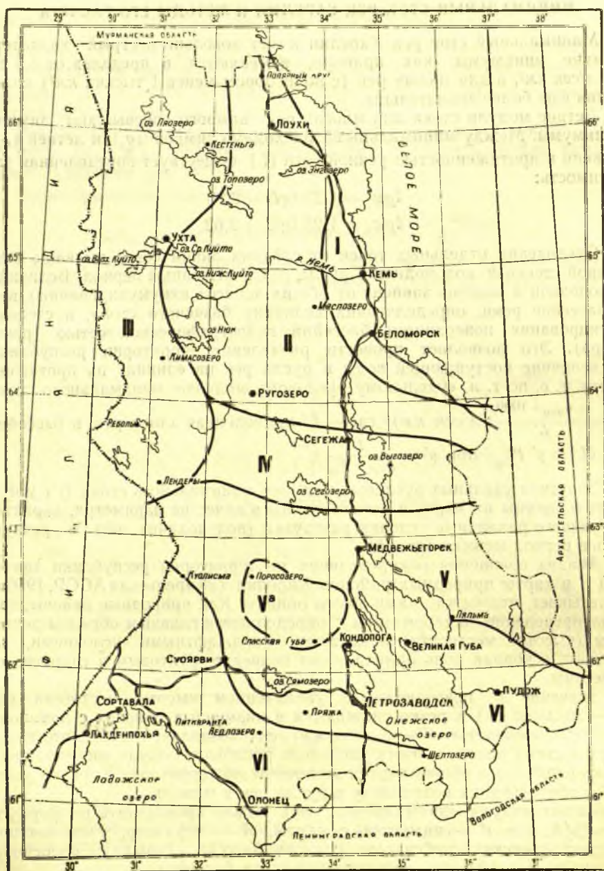
Рис. 5. Схематическая карта распределения удельного руслового модуля минимального стока ( r' ) в Карелии по зонам (л/сек. км). Для зимы: I—2—5; II—5—10; III—10—15; IV—10—15; V—5—10; Va—10—12; VI—3—5. Для лета: I—3—5; II—10—15; III—15—20; IV—10—15; V—10—15; Va—15—17; VI—3—5.
