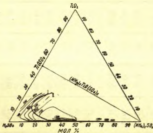
Рис. 4. Проекция изотермы растворимости системы \text{TiO}_2\text{—H}_2\text{SO}_4\text{—}(\text{NH}_4)_2\text{SO}_4\text{—H}_2\text{O} при 80^\circ .
