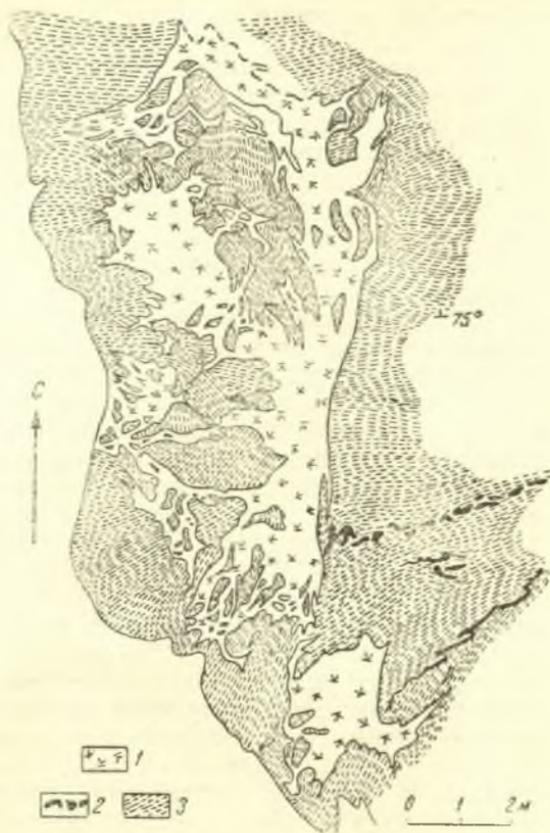
Рис. 11. Характерная форма пегматитового тела, цементирующего брекчированные ладожские биотито-кварцевые сланцы
