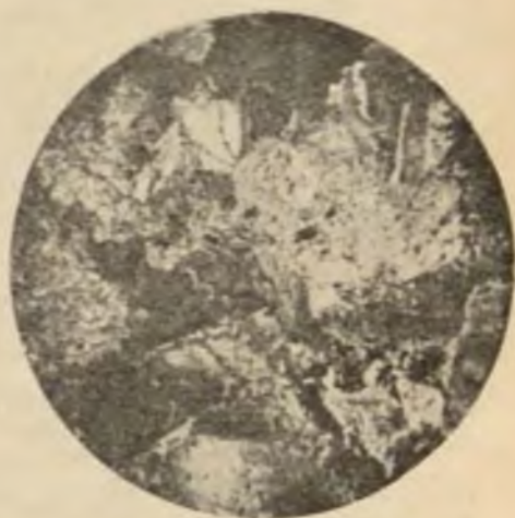
Рис. 7. Бластофитовая структура в габбро.
