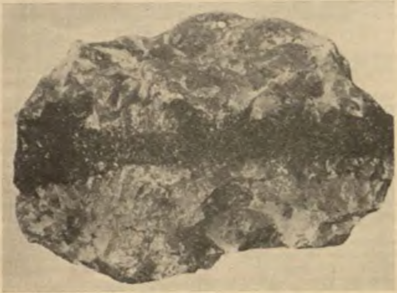
Рис. 2. Жилка куммингтонитового амфиболита, секущая кварцит.
