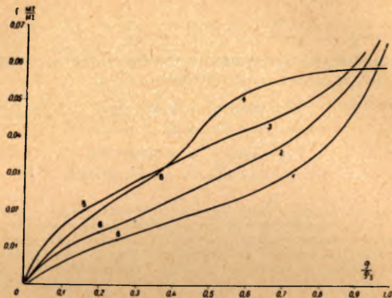
Рис. 1. Изотермы адсорбции водяного пара на сульфатном (1—3) и гидролизном (4) лигнинах сосны.
