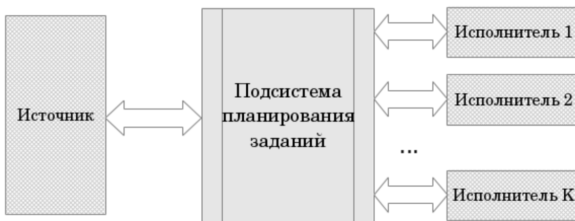
Рис. 1.3. Структура системы Desktop Grid.
