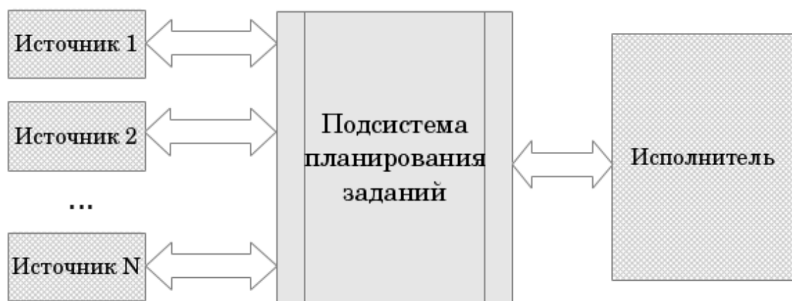
Рис. 1.1. Структура вычислительного кластера.
