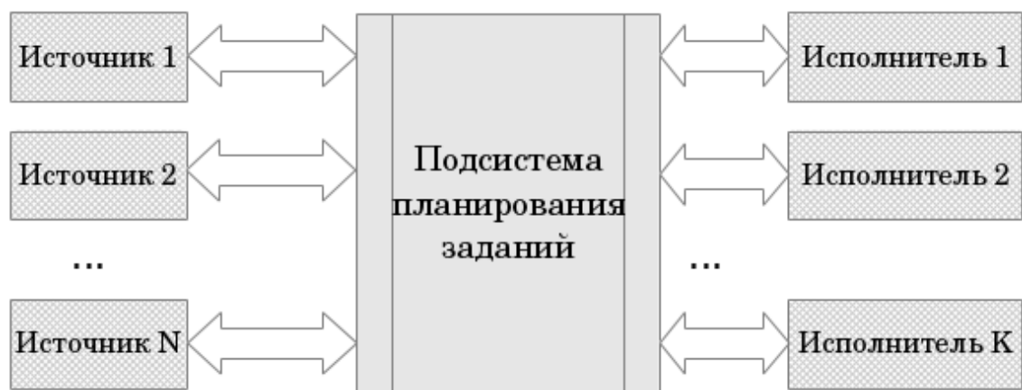
Рис. 1.2. Структура распределенной вычислительной системы.
