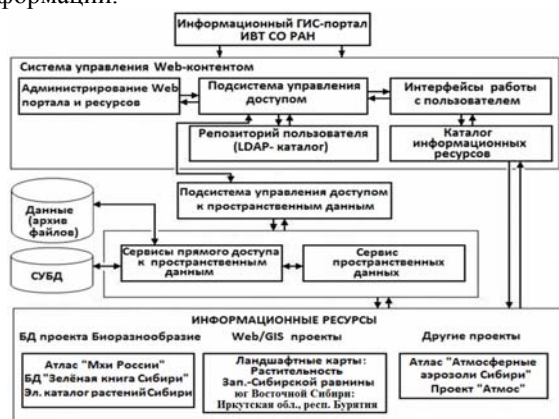
Рис. 1. Структура распределенной ГИС
