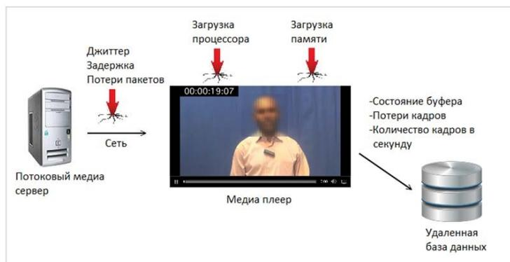
Рис. 1. Медиа плеер посылает различные характеристики в удаленную базу данных
