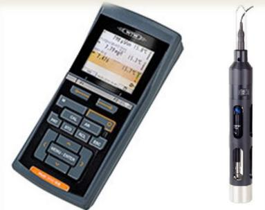
Для гидрохимических измерений использовалось оборудование: портативное полевое устройство для анализа WTW Multi 3630, включающее встроенные датчики температуры и глубины, а также съемные датчики измерений pH IDS pH combined electrode SensoLyt 900-P, проводимости IDS Conductivity measurement cell TetraCon 925-P и кислорода IDS Oxygen measurement cell FDO 925-P. Фиксация значений прибора в вертикальном срезе производилась через каждый 1 м.
