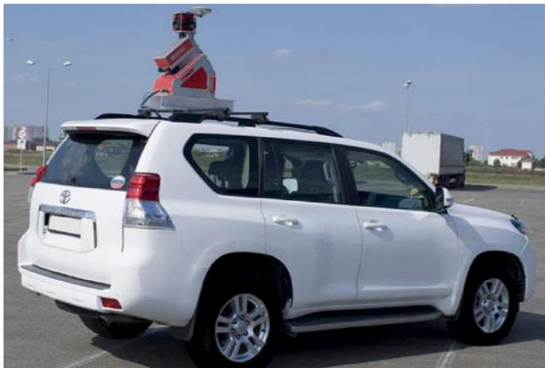
Рис. 1. Автомобиль, оснащенный лазерным сканером АГМ-МС7
