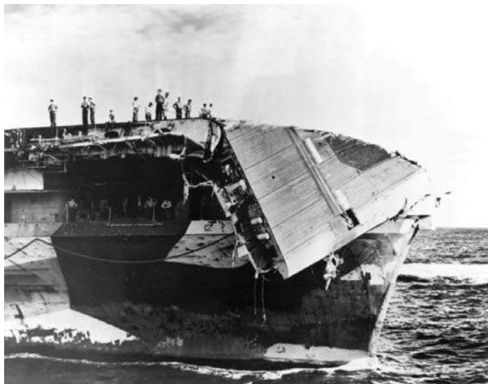
Американский авианосец «Хорнет» (USS Hornet, CV-12) с полетной палубой, поврежденной тайфуном. 5 июня 1945 г.
