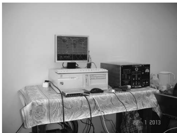
Рис. 3. Радиотомографический приемник сигналов на частотах 400 и 150 МГц искусственных спутников Земли для изучения ионосферных полей
