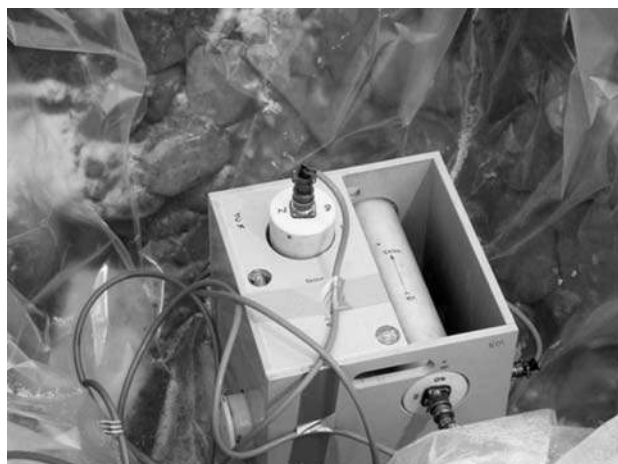
Рис. 4. Индукционный магнитометр для измерений вариаций и микропульсаций геомагнитного и геоэлектрического полей
