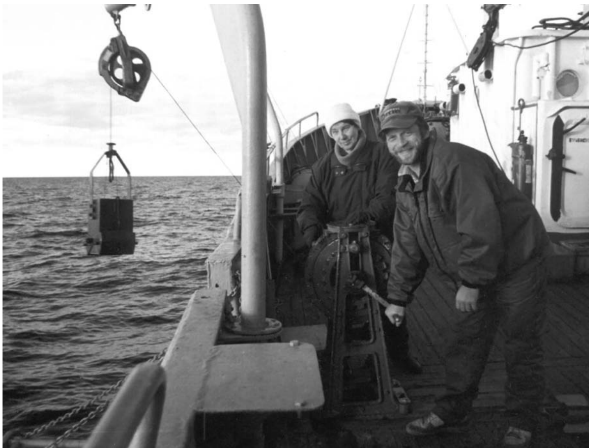
Рис. 6. Отбор поверхностных проб донных отложений на Ладожском озере (сентябрь 2000 г.) с помощью дночерпателя «Экмана» с борта НИС «Талан». На палубе д. б. н. Н. Н. Давыдова и д. г. н. Д. А. Субетто
