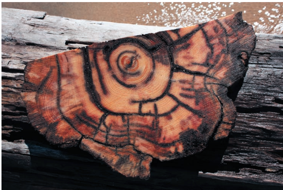
Рис. 3. Дендрохронологический образец в виде сектора, выпиленный из пня сосны
