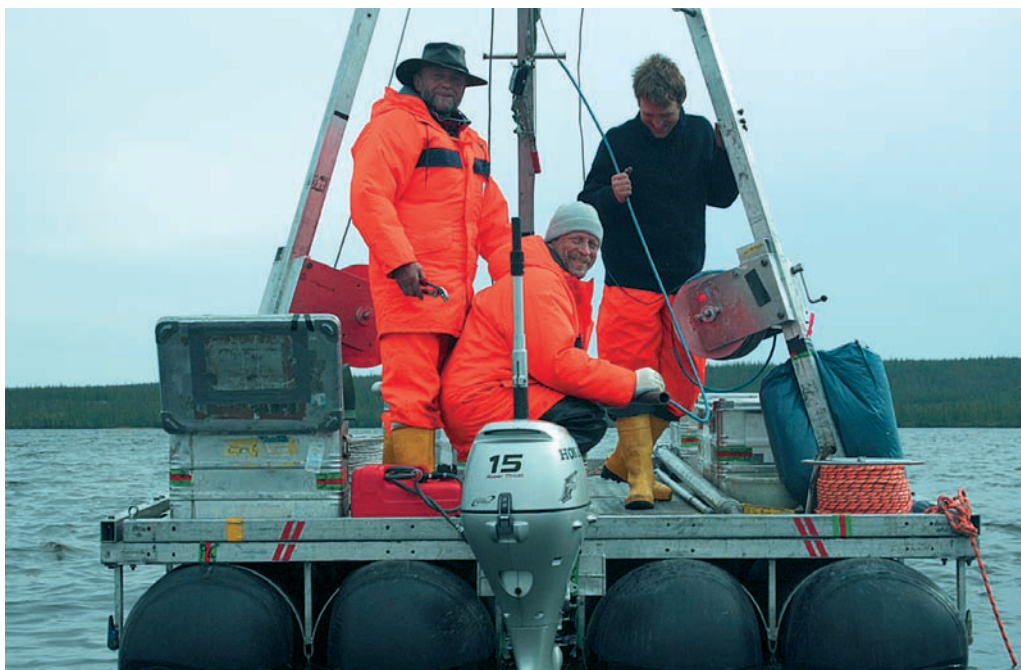
Рис. 3. Отбор кернов донных отложений с плавучей платформы на оз. Кютюнда, северная Якутия, 2010 г.
