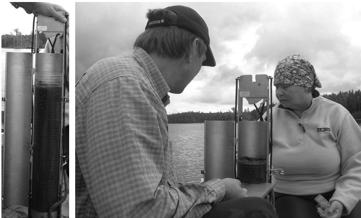
Рис. 2. Отбор проб пробоотборником «Limnos»
