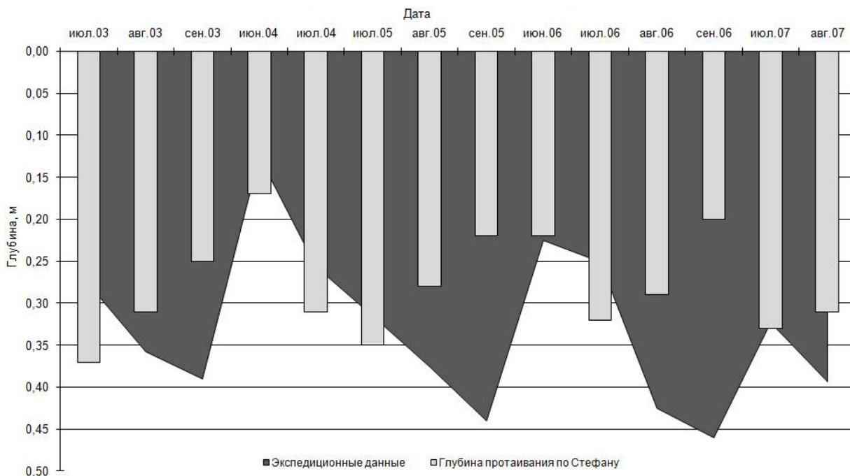
**Рис. 4. Сопоставление рассчитанных значений глубины протаивания (по Стефану) и экспедиционных данных**
