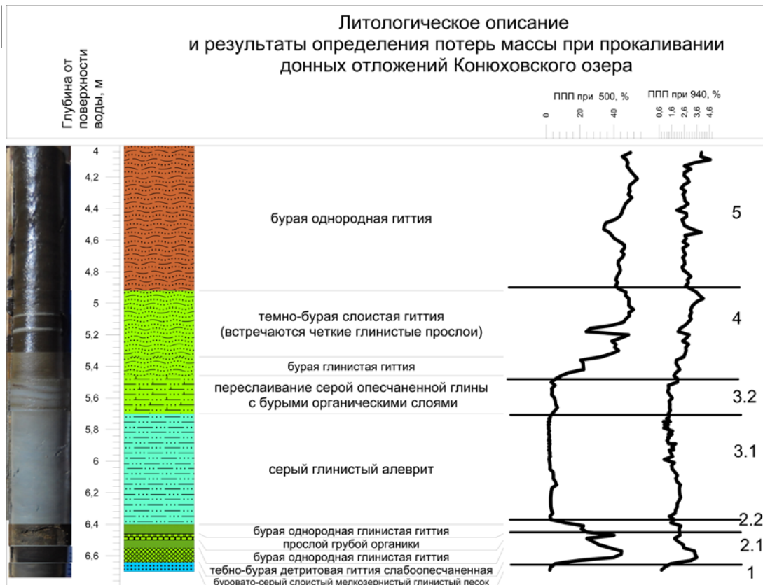
Рис. 3. Литологическое описание и данные потерь при прокаливании донных отложений озера Конюховского.
