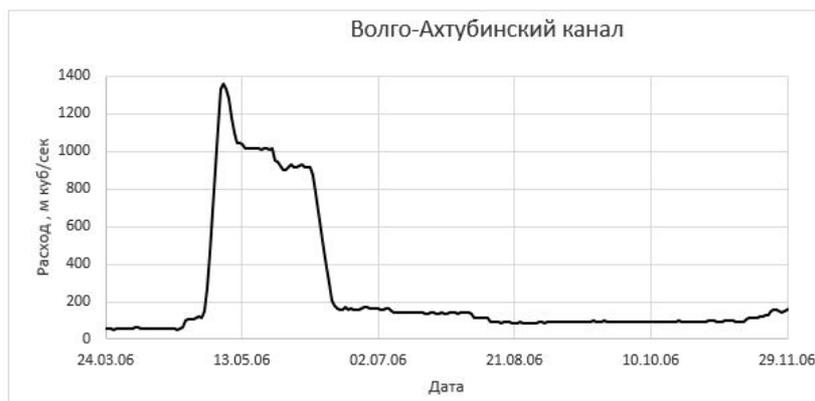
Рис. 1 – Модельный гидрограф в Волго-Ахтубинском Канале, 2006 г.
