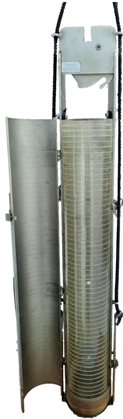
Gravity corer «LIMNOS»
